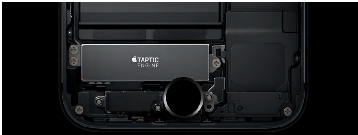
Rysunek 2.8. Mechanizm Taptic Engine w obudowie urządzenia firmy Apple.
